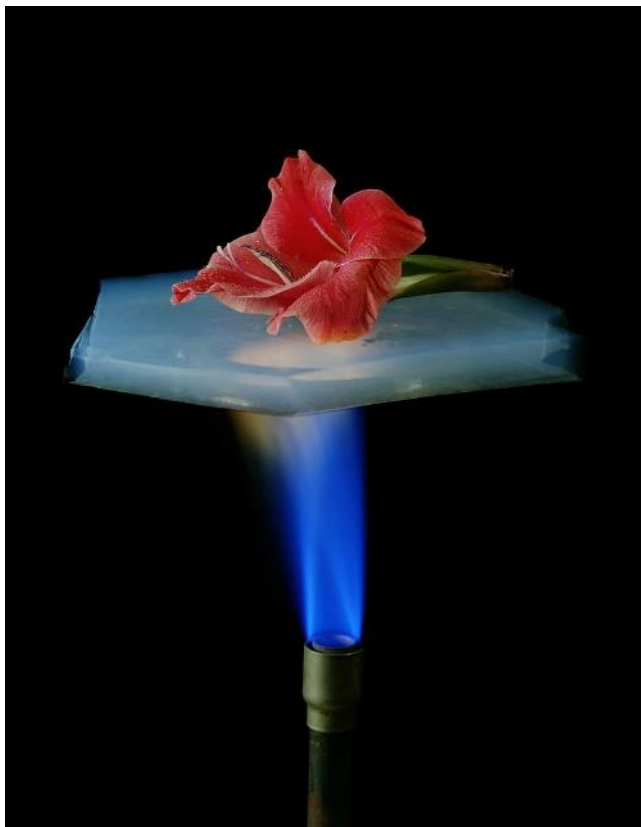
Obrázek 6: Aerogel jako tepelný izolant
